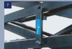
Bras de support : Assure la protection de l'opérateur lorsqu'il effectue des travaux de réparation ou de maintenance
