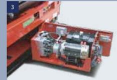
Système hydraulique et électrique
